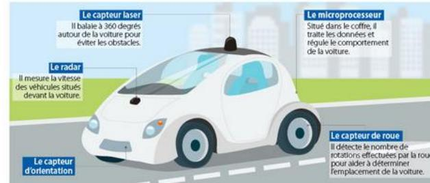
a. Pourquoi le capteur laser est-il situé au-dessus de la voiture ?
